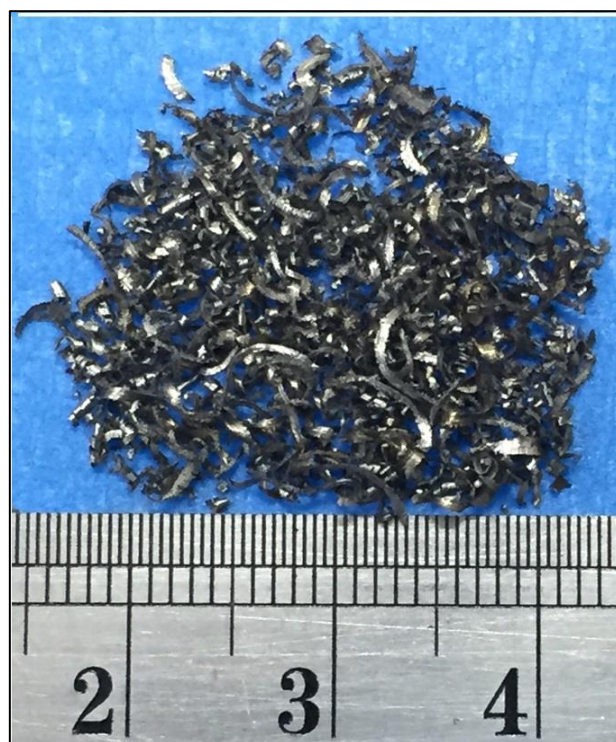
Figura 1. Macrografia dos cavacos como recebidos apresentando uma distribuição heterogênea de morfologia e de comprimento (até 5 mm).
