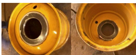
Figura 6. Aro da roda lado externo e interno com chanfro duplo V.
