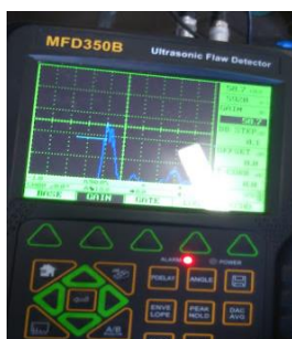
Figura 10. Resultado do END por ultrassom.
