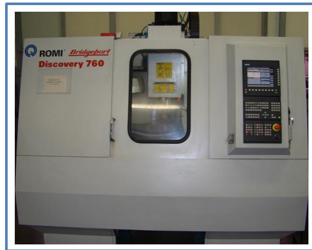
Figura 4 – Centro de usinagem vertical CNC utilizado nos testes de fresamento
