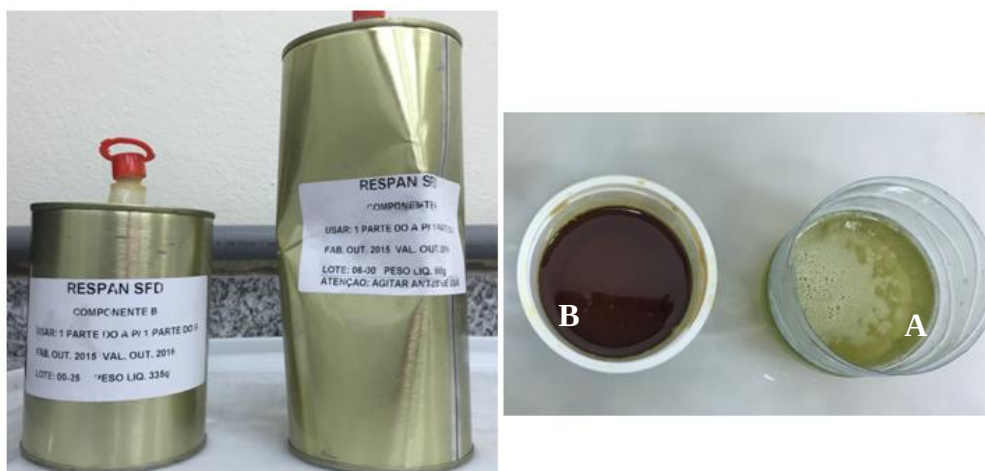
Figura 1. Componentes A e B do poliuretano.
