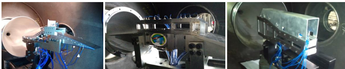
Figura 3. Modelos fabricados em metal e ensaiados no Túnel de Choque Hipersônico T3.
