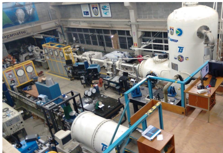
Figura 2. Túneis de Choque Hipersônicos T2 e T3.
