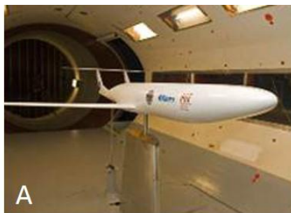
Figura 4. Veículos prototipados testados em túnel de vento “Fonte: Mark Drela, 2011”
