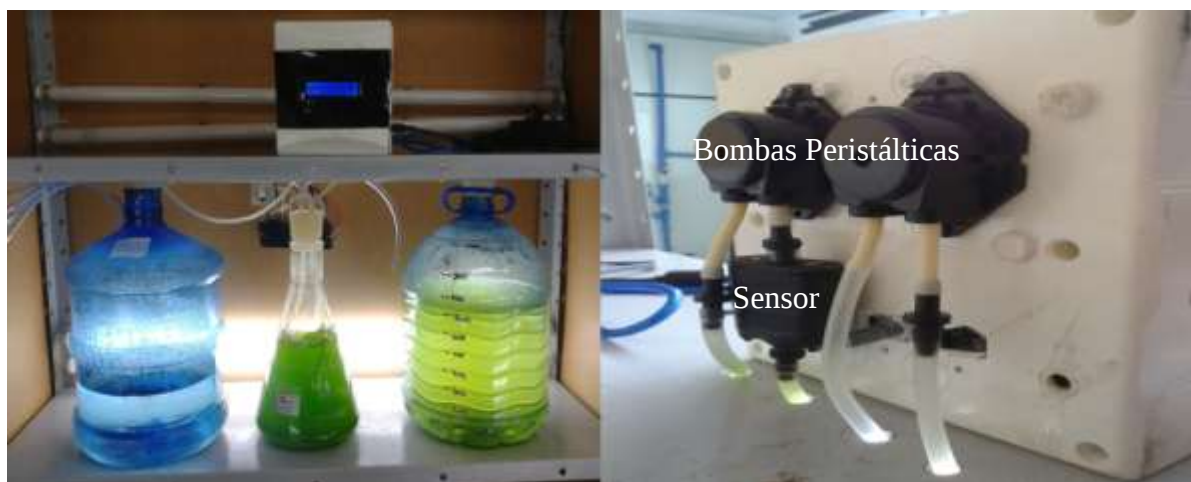
Figura 9. À direita: sistema em funcionamento num biorreator tipo “Enlarmeyer 2 litros”. À esquerda, bombas e sensor em detalhe.
