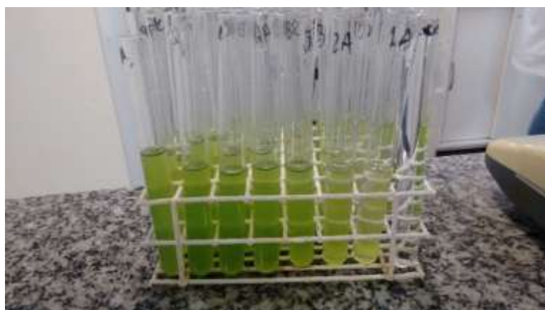
Figura 7. Diluições utilizadas na calibração do sensor.
