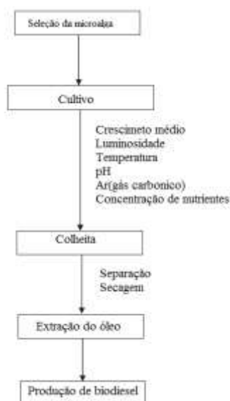
Figura 4. Etapas do processo de conversão da biomassa de microalgas em biodiesel Fonte: Ahmad et al, 2010.
