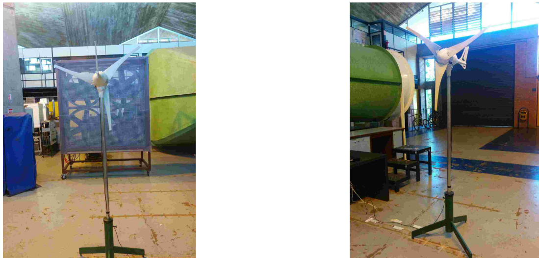
Figura 9: Montagem experimental da turbina no túnel de vento aberto.
