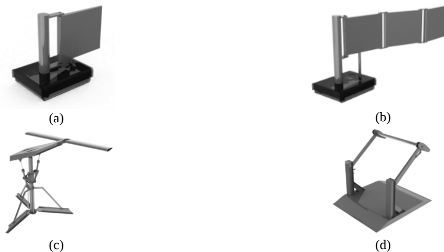
Figura 3. Modelos de Hidrofólios Oscilantes desenvolvidos: (a) 1º Modelo: com uma placa na vertical; (b) 2º Modelo: com três placas na vertical; (c) 3º Modelo: com perfil hidrodinâmico na horizontal com um braço; e (d) 4º Modelo: com perfil hidrodinâmico na horizontal com dois braços.
