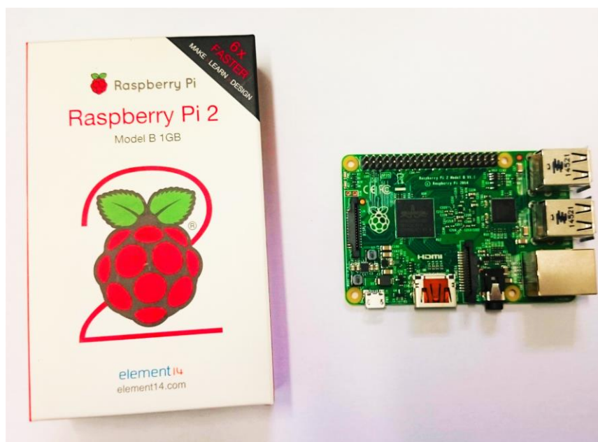
Figura 4. Módulo computacional de interface homem/máquina Raspberry Pi 2B .
