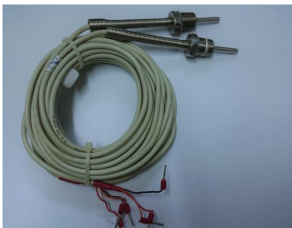
Figuras 5 e 6. Equipamentos do módulo de temperatura do combustível: Termômetro resistor Pt-100 e Controlador PHI-ID.
