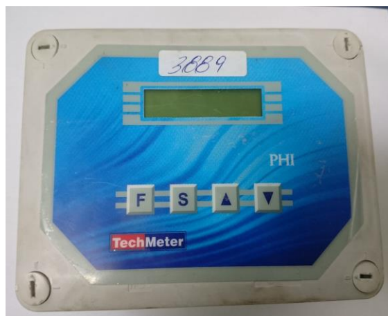
Figuras 5 e 6. Equipamentos do módulo de temperatura do combustível: Termômetro resistor Pt-100 e Controlador PHI-ID.
