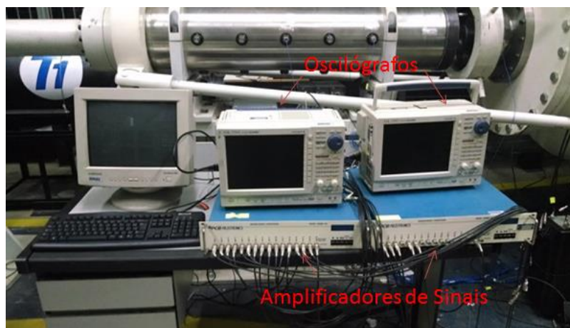
Figura 3: Sistemas de aquisição de dados, amplificadores, oscilógrafos e computador (Martos, 2014).
