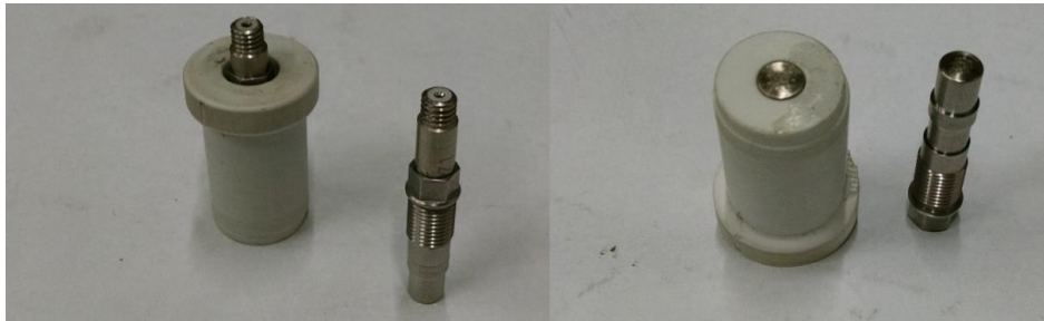
Figura 2: Transdutor de pressão e transdutor de pressão instalado no alojamento (Martos, 2014).
