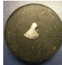
Figura 2. Nióbio fundido em arco elétrico.
