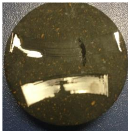
Figura 1. Lâmina de nióbio no Baquelite.
