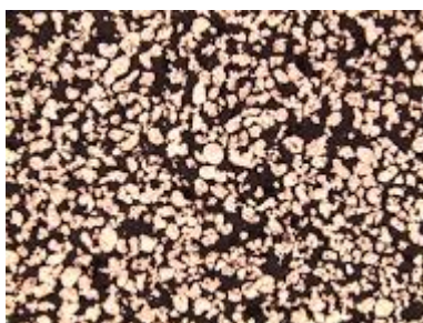
Figura 4. Imagem de pó de cobre sinterizado obtida por microscópio ótica 100x.
