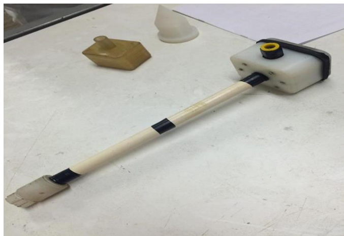
Figura 2. Tubo de vórtice utilizado nos testes
