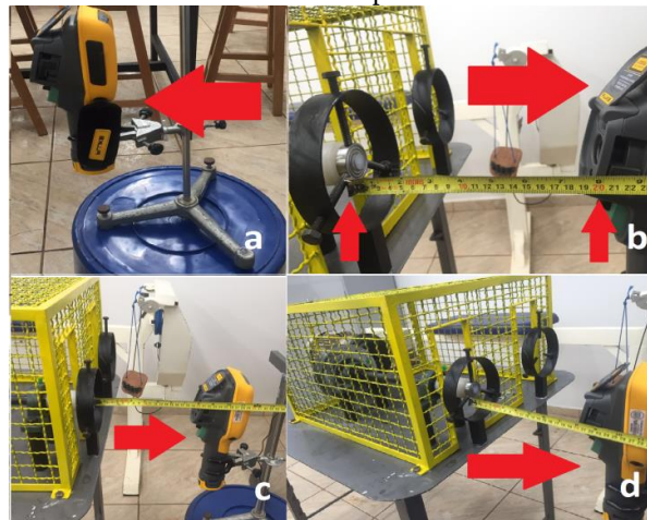
Figura 5 – Equipamento Fluke Ti125 ® fixado em suporte a uma distância de 20 cm do rolamento.
