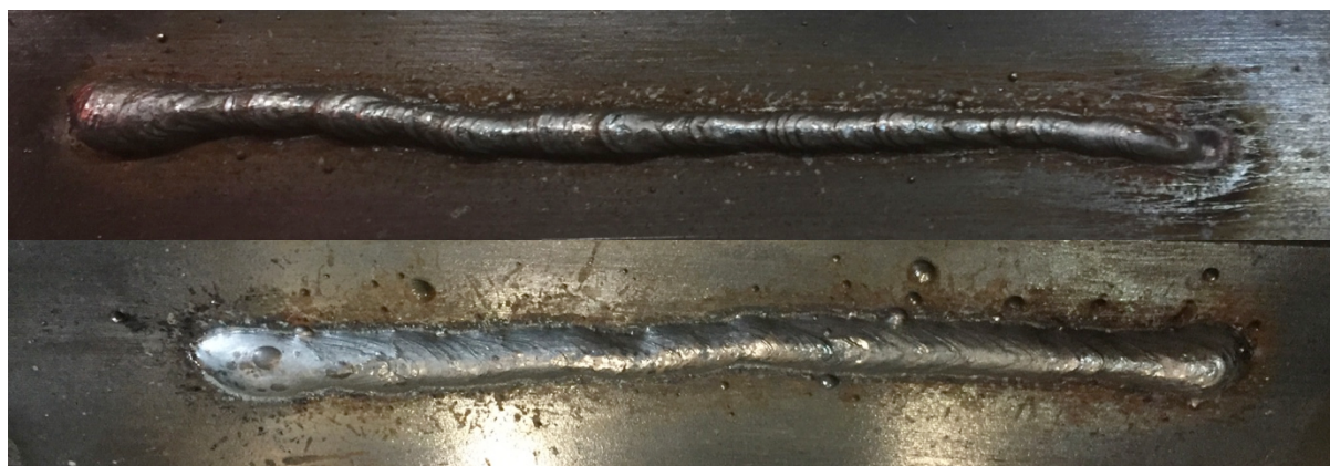
Figura 9. Aspecto final do cordão de solda com variação de DBCP e junta para CC (cima) e VL (baixo).
