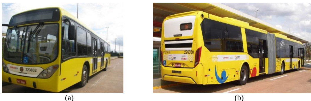
Figura 4. Ônibus que operam no Sistema BRT Brasília: (a) Chassi Padrão e (b) Chassi Articulado
