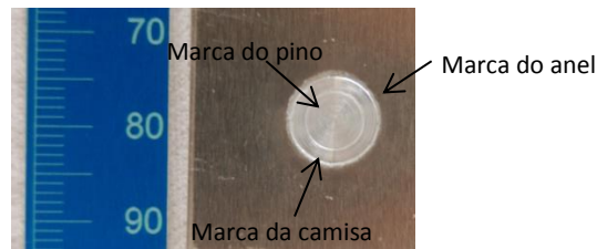
Figura 3 - Acabamento superficial da junta soldada
