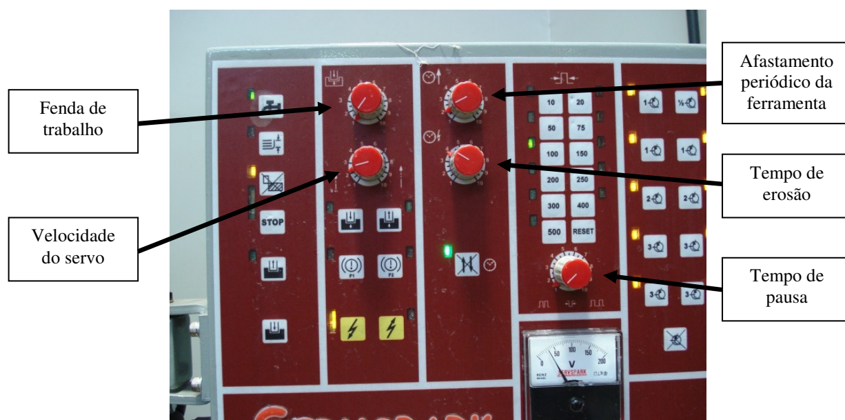
Figura 3. Painel de controle da máquina de eletroerosão com indicação dos parâmetros ajustados.
