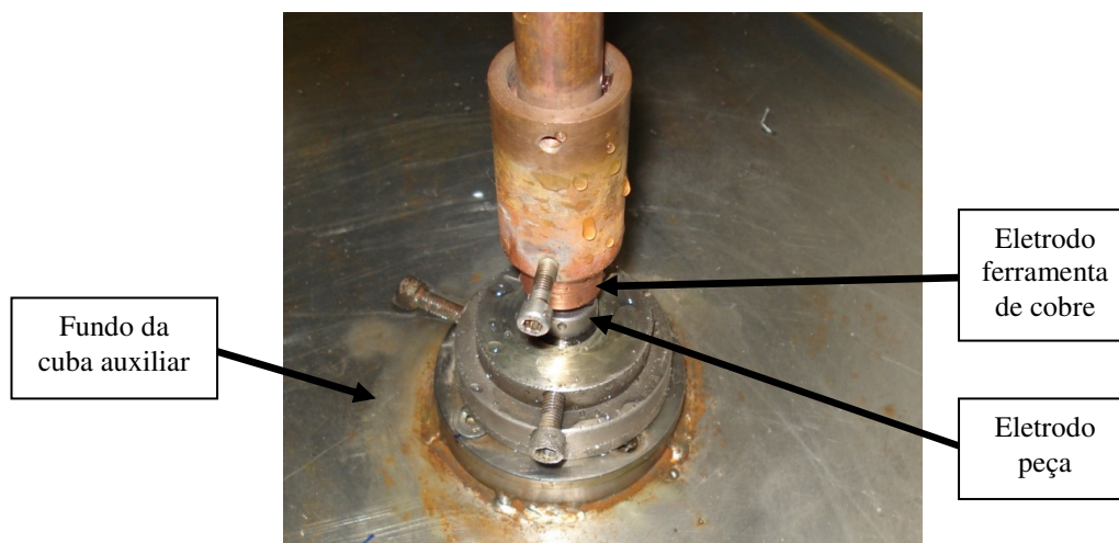
Figura 2. Eletrodos ferramenta e peça posicionados no interior da cuba auxiliar.
