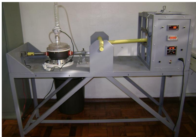
Figura 2. Dispositivo para ensaio CST carga constante
