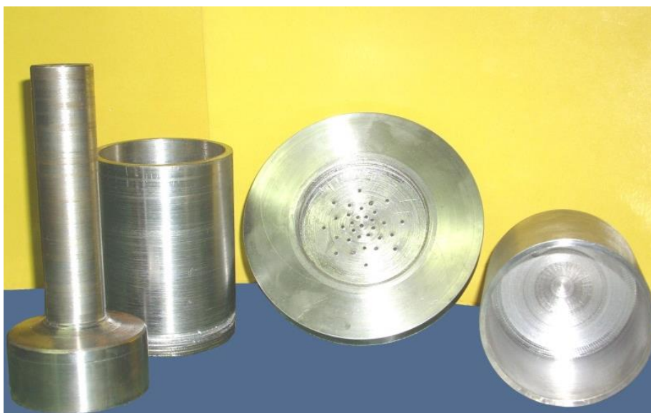
Figura 5: Prensa para extração de óleo das oleaginosas, projetada e construída no Laboratório de Mecânica e Materiais do IFMA para desenvolvimento de pesquisa. Fonte: Mafra, 2008.
