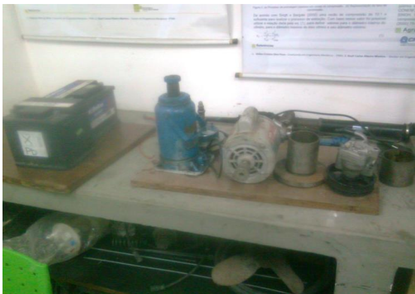
Figura 6: Elementos do circuito hidráulico da prensa com a sua estrutura antes da montagem.
