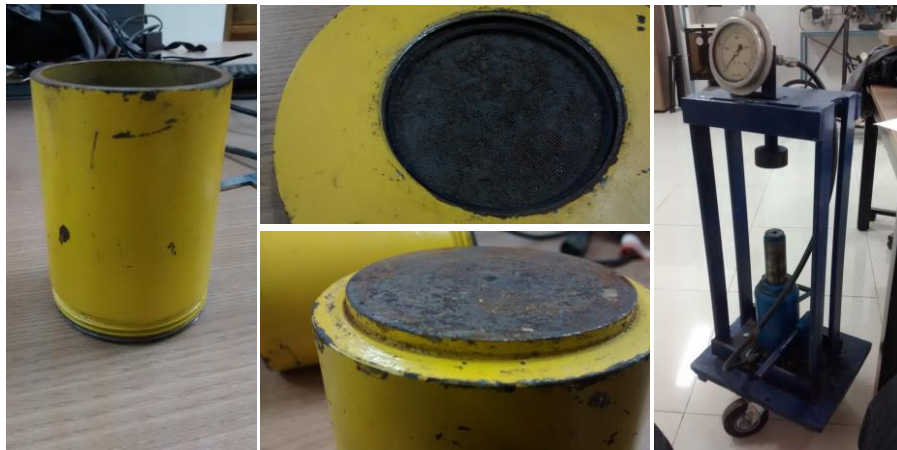
Figura 8: Estrutura com Prensa Mecânico/Hidráulico e detalhes do copo onde é extraído o óleo.
