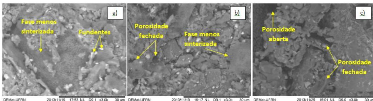
Figura 2. Micrografia da formulação I sinterizados a a) 1000°C, b) 1050°C e c) 1100°C, com aumento de 3000x.
