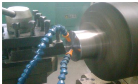
Figura 6. Realização dos experimentos para Desgaste Superficial da superfície usinada sob aplicação de Fluido de Corte.
