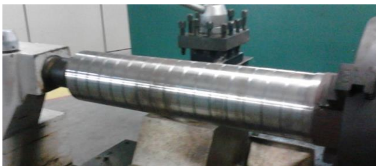
Figura 4. Aço ABNT 1045 usado no experimento, adquirido na forma de barras cilíndricas, e as respectivas separações.
