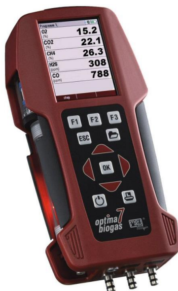
Figura 2. Analisador portátil modelo Optima 7 fabricado pela MRU Instruments .
