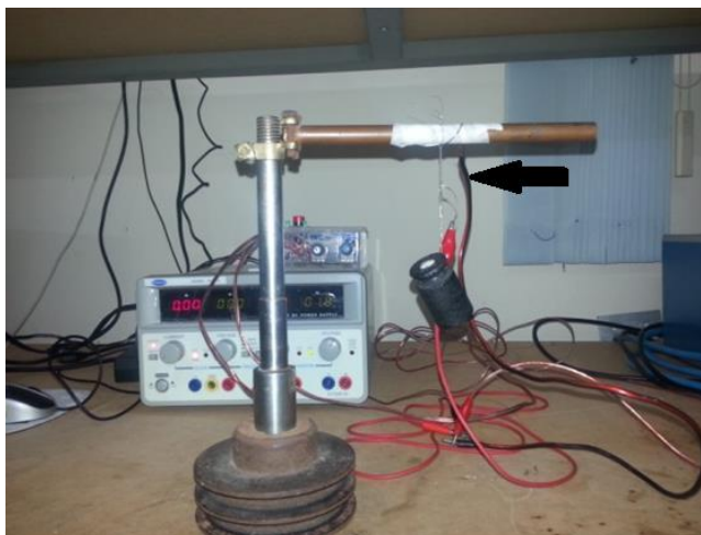
Figura 2. Montagem específica utilizada para o treinamento cíclico da mini mola de LMF Ni-Ti.
