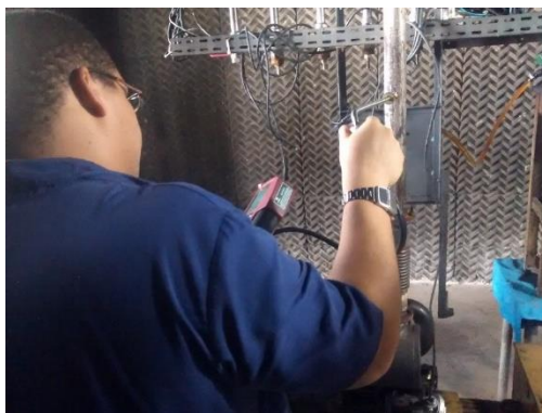
Figura 6: Medição das espécies de gases na tubulação de escape motor YANMAR.
