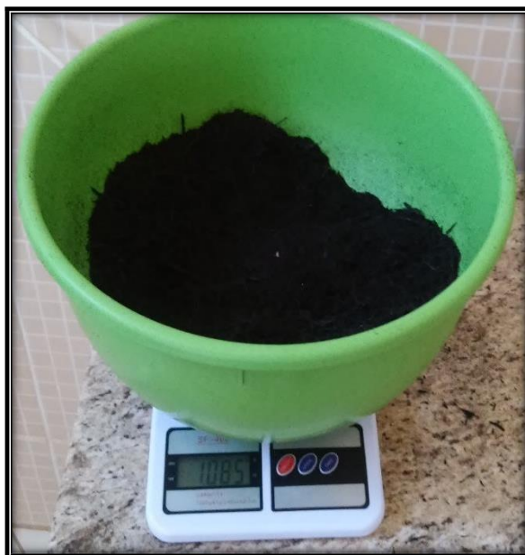
Figura 3: Pó de pneu para queima em caldeira
