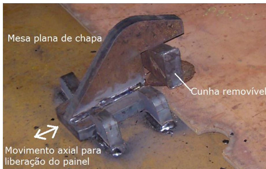
Figura 9, Dispositivos de fixação com movimento axial para liberar a peça soldada. Autores (2011)
