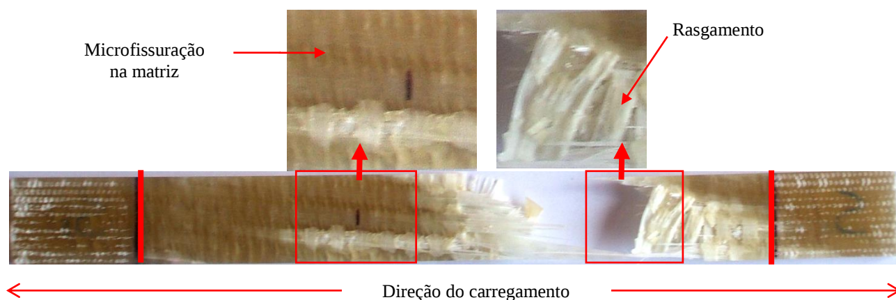
Figura 3. Característica da fratura final - Laminado LV – Estado original.
