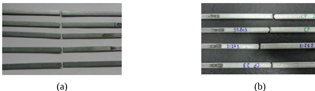
Figura 12. Amostras de fio de aço galvanizado seção retangular após de serem testadas (a) Fio A e (b) Fio B.
