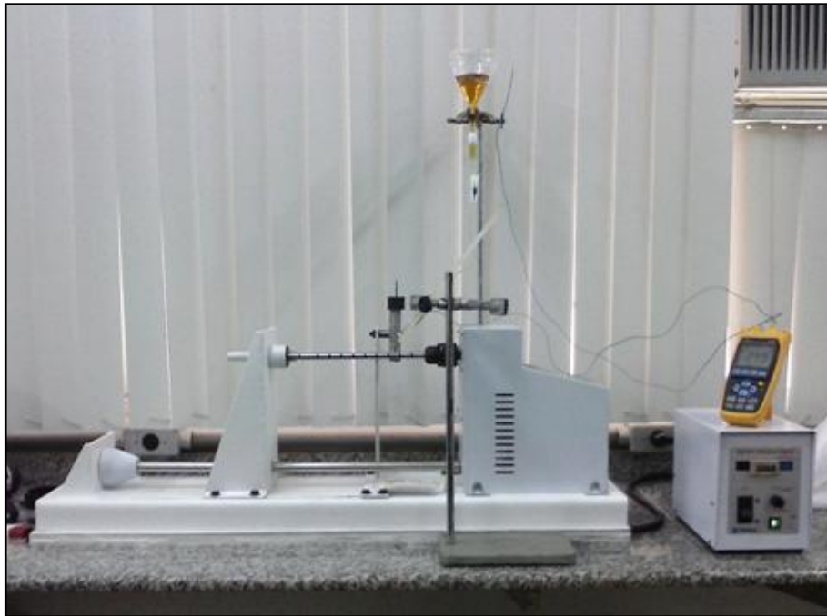
Figura 03: Bancada do ensaio de desgaste relativo ao atrito.
