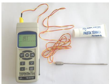
Figura 9a – Termopar Tipo K e Termômetro com Data Logger e Pasta Térmica
