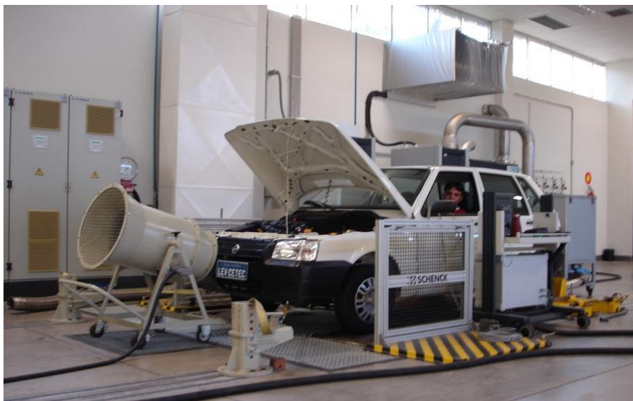
Figura 1. Exemplificação de um veículo posicionado no dinamômetro para realização dos testes.
