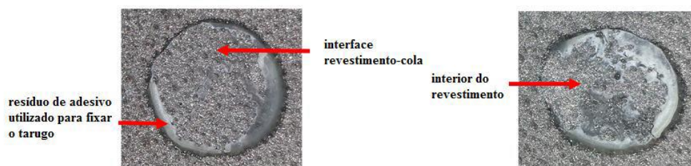
Figura 9. Resultado do teste de pull-off para a condição 2.
