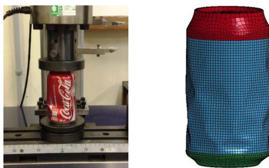
Figura 11: Comparativo da flambagem por meio do ensaio experimental e da análise dinâmica transiente explícita.
