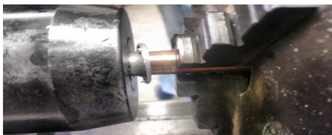
Figura 6. Tentativa de solda dissimilar entre alumínio e cobre, (“mergulhamento” do cobre no alumínio)
