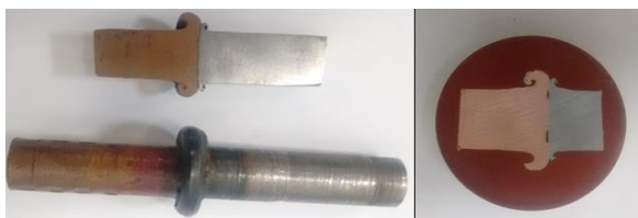
Figura 12. Solda dissimilar aço 1020 e cobre.
