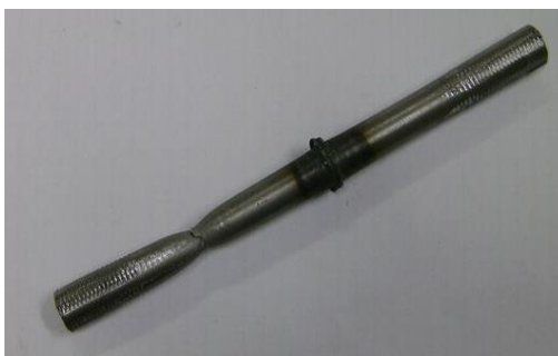
Figura 14. Amostra soldada de aço 1020 após sofrer ruptura.
