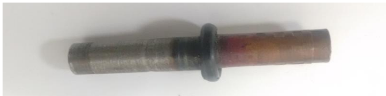
Figura 7. Solda dissimilar Aço 1020 e cobre
