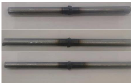
Figura 8: Amostras soldadas do aço 1020 obtidas com a variação da pressão.
