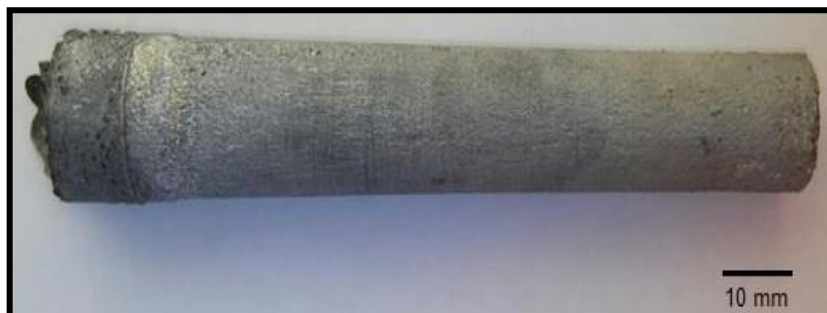
Figura 2. Lingote da liga AA2024 obtido através do processo de tixoforjamento.
