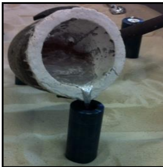
Figura 1. Etapa de vazamento no processo de fundição da liga AA2024.
