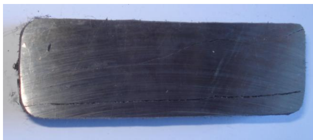
Figura 2. Foto de um dos corpos de prova preparado para ensaio de roda de borracha.
