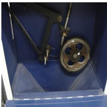
Figura 4. Foto do equipamento utilizado no ensaio de abrasão por roda de borracha.
