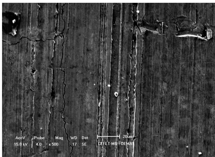
Figura 8. Imagem de MEV da trilha de desgaste na liga A.
