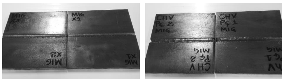
Figura 4. Foto dos CP's MX e MV, respectivamente, após soldagem.
