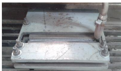
Figura 8. A figura mostra o CP soldado no dispositivo de fixação.
