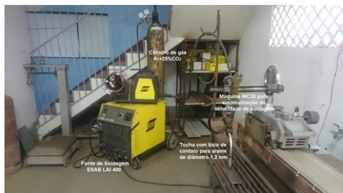
Figura 3. Foto ilustrativo do arranjo utilizado para realização das soldagens em “V” e “X”.
