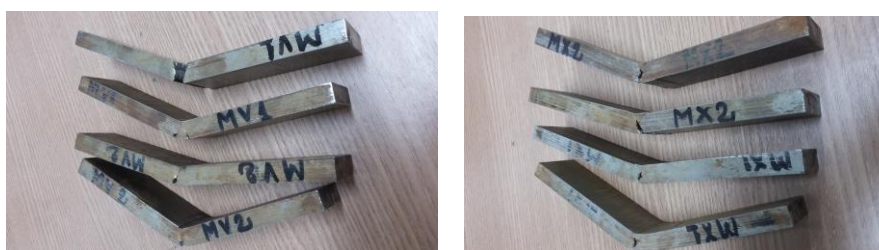
Figura 14. Corpos de prova dobrados e que apresentaram trinca ou se romperam.
