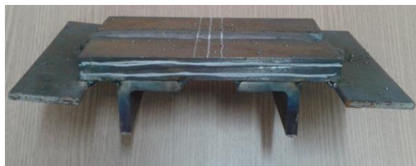
Figura 6. Chapas soldadas em V, mostrando na parte de baixo as cantoneiras de ancoragem e nas laterais as chapas de início e fim da soldagem
