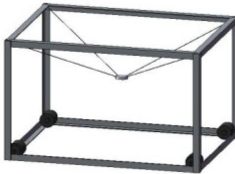
Figura 5: Manipuladores incompletos de cinemática restrita (TRAVI 2009).
