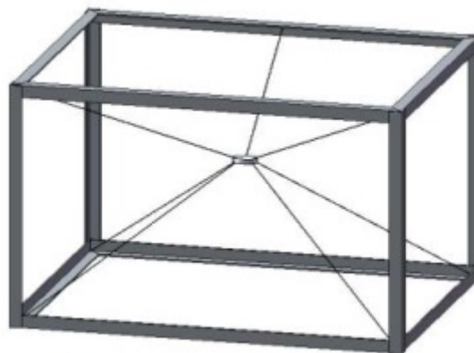
Figura 7: Manipuladores atuados redundantemente (TRAVI 2009).
