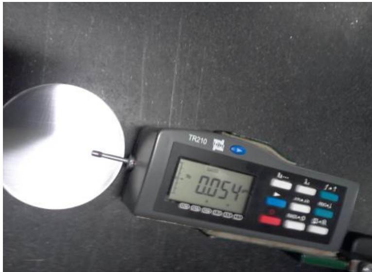
Figura 3. Verificação da rugosidade superficial do disco.
