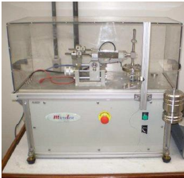
Figura 1. Tribômetro esfera sobre disco fabricado pela Micro Photonics INC.
