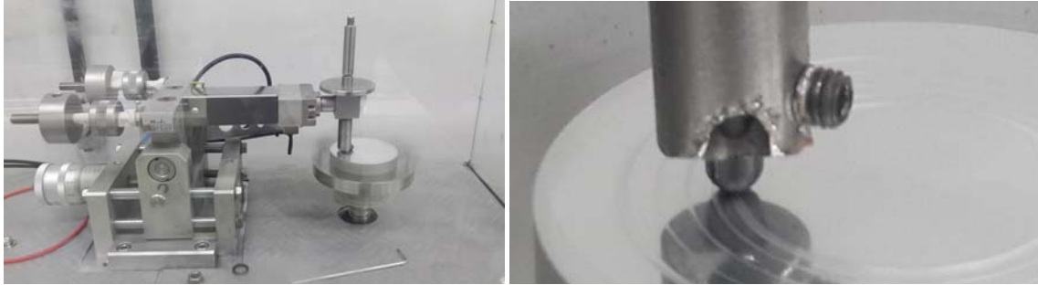
Figura 6. Na esquerda tribômetro de pino sobre disco MICROTTESTS e na direita pino de metal duro microgrão revestido com (Ti,Al)N sobre disco de liga de Alumínio 6262-T6.
