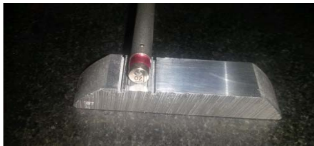
Figura 12. Medição de rugosidade no rugosímetro SURTRONIC 25.
