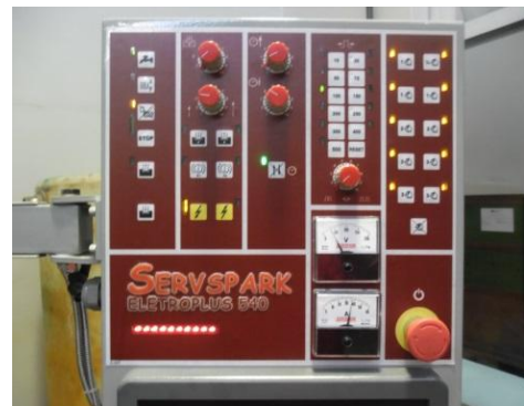
Painel de controle para ajuste dos parâmetros operacionais.
