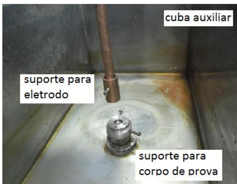
Figura 2. Imagem do porta eletrodo e corpo de prova.
