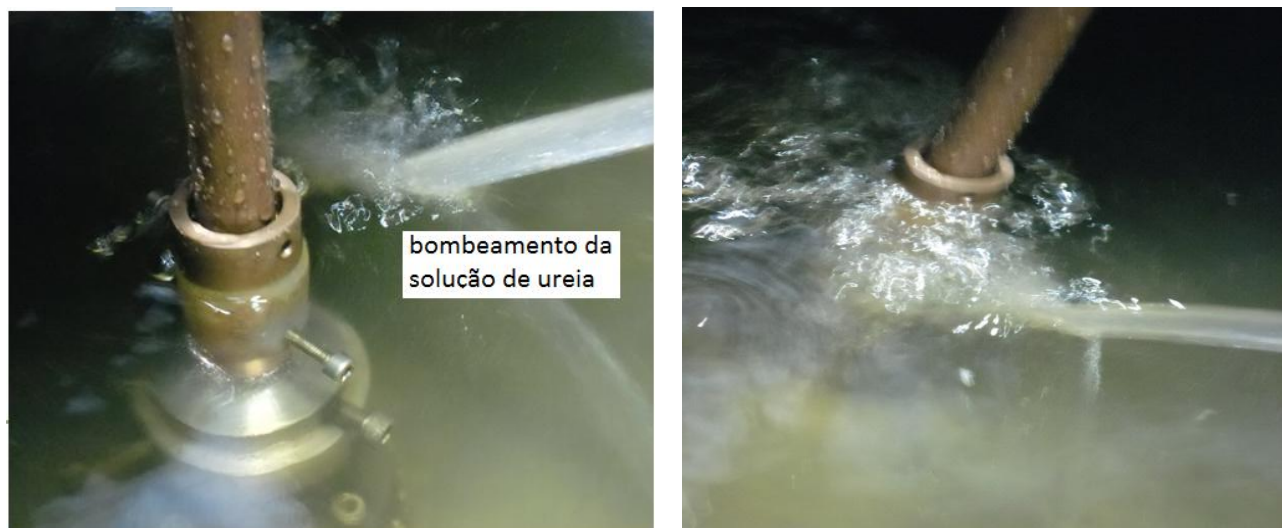
Figura 3. Imagens da limpeza por jato.
