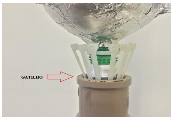
Figura 4. Abraçadeiras usadas como gatilho.
