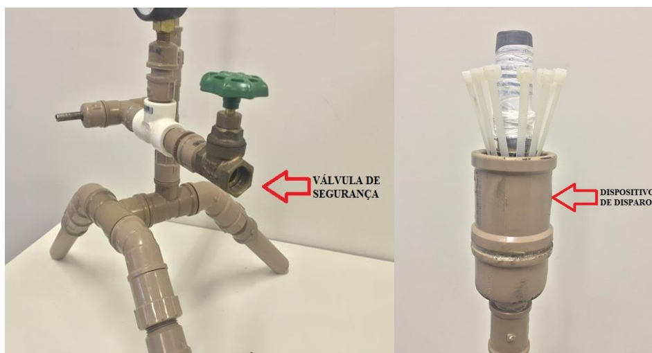
Figura 3. Estrutura da base junto com a válvula de segurança e o dispositivo de disparo.
