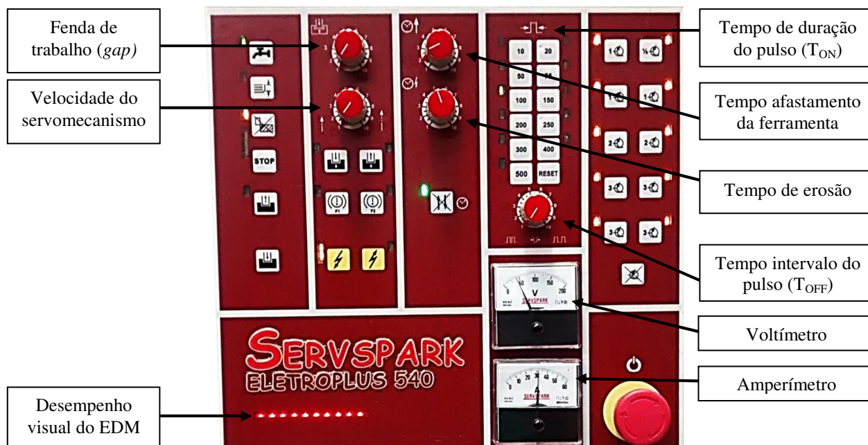
Figura 3. Painel de controle da máquina EDM com indicação dos parâmetros ajustados.
