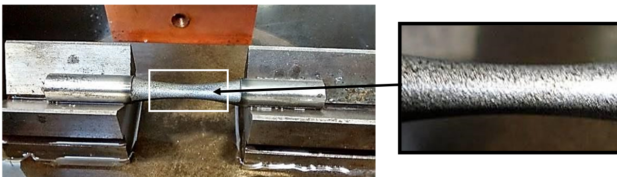
Figura 7. Corpo de prova em aço ABNT 4140 usinado pelo processo EDM com matriz de cobre.
