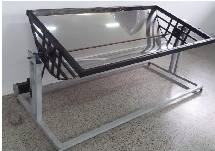
Figura 1. Fotografia do concentrador solar parabólico.
