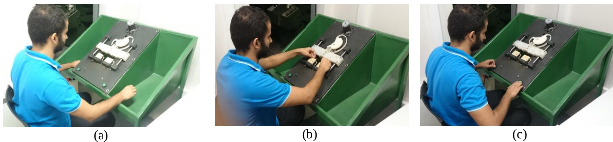
Figura 13. (a) Pega da castanha – duas castanhas; (b) Alimentando a máquina - duas castanhas; (c) Acionamento do ciclo de decorticação da castanha.
