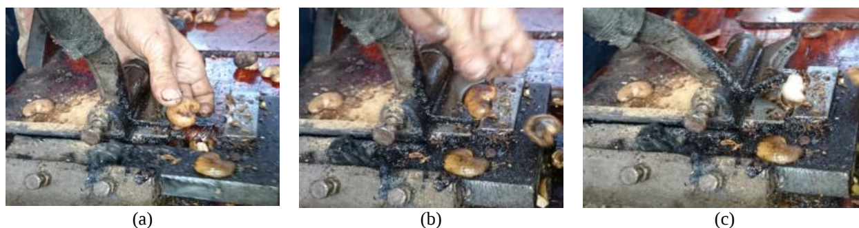
Figura 2. (a)Aproximação da castanha entre as laminas, (b)Avanço da lâmina de perfuração contra as lâminas de corte, (c)Abertura do conjunto de lâminas bipartida
