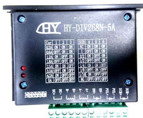
Figura 10. Driver para acionamento dos motores de passo.
