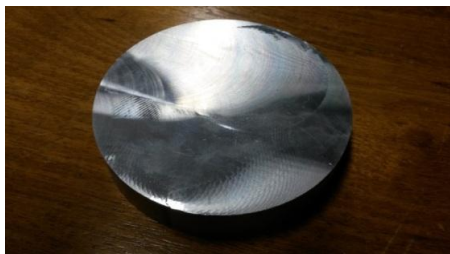
Figura 1. Corpo de prova de liga de Alumínio 6262-T6
