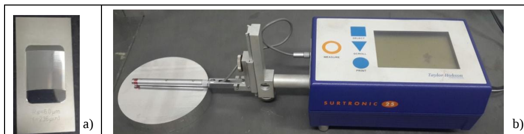
Figura 2. a) Padrão de calibração, b) Medição da rugosidade
