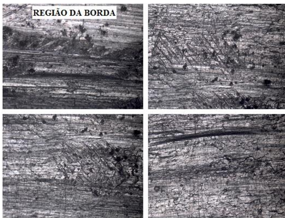
Figura 8 – Regiões distintas da peça fabricada utilizando o Quimatic como fluido lubrificante.
