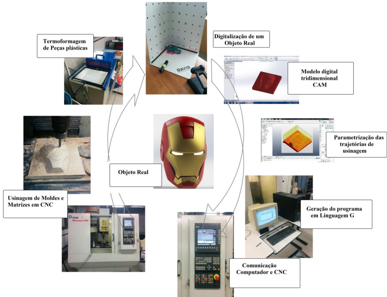
Figura 2: Proposta de Ambiente Integrado de Manufatura para produção de peças plásticas
