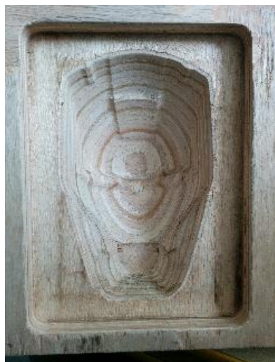
Figura 6: Usinagem negativa da parte posterior do molde
