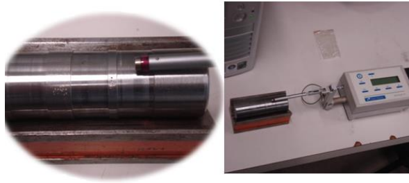
Figura 4. Medição do desgaste diametral do rebolo
